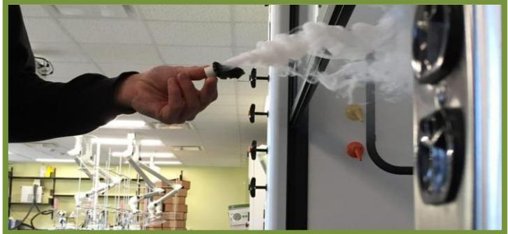
**PROVE ON SITE: VERIFICA DELLA BARRIERA FRONTALE (FACE VELOCITY TEST) – rif. 2) C**
